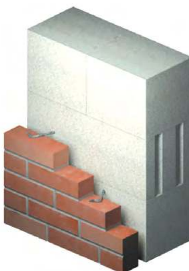
Рис. 7б. Облицовка с непосредственным креплением
