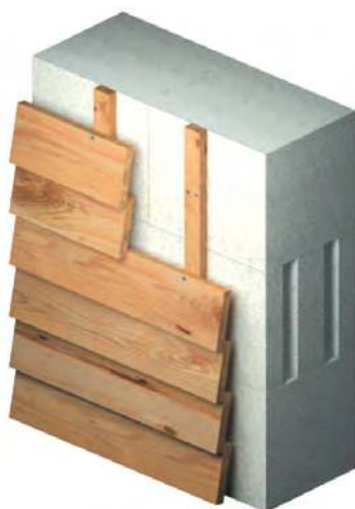
Рис. 7а. Облицовка по направляющим
