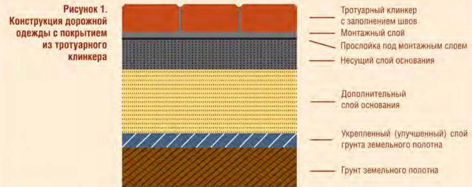
**Несущее основание** – часть дорожной одежды, обеспечивающая совместно с покрытием перераспределение и снижение давления на нижележащие дополнительные слои или грунт земляного полотна. Основание может быть выполнено из различных материалов: щебня, укладываемого с расклинкой; песко-цементной смеси; щебня, укрепленного цементом или расклинцованным песко-цементной смесью или других материалов, модуль упругости которых превышает 180 МПа.
