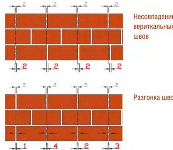
**4.** Заполнение швов производится в процессе укладки клинкера. Во избежание смещения кирпичей заполняются каждые 2 ряда.
