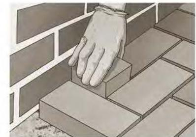
В местах примыкания мощения к границам площадки всегда остаются пустоты, меньше целого кирпича по размеру. Они заполняются доборными кирпичами, которые изготавливают при помощи отрезной пилы («болгарка» или циркулярная пила с диском для камня).
