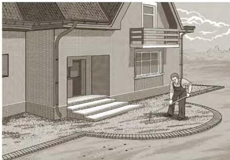
Подсыпка равномерно распределяется по поверхности несущего слоя и предварительно разравнивается с помощью подручного инструмента (например, граблей). Монтажный слой трамбуется (уплотняется) специальным электро- или бензоинструментом (виброплитой).
