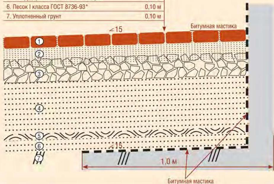
Гидроизоляция подземных частей зданий выполняется, как показано на рис. 4. Уплотненному дну котлована придается уклон от стен здания к фундаменту, приклеивается рулонная вертикальная гидроизоляция, которая заводится на 1-1,5 м на дно котлована, а поверх устраивается основание под мощение. Таким образом, вода, дренирующая через подстилающие слои песка и щебня, отводится от фундамента.
