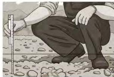
При подготовке несущего слоя осуществляется разметка участка. В ходе разметки участка определяются высоты, углы, направление уклона для дренажа. Для фиксации разметки натягиваются нити.
